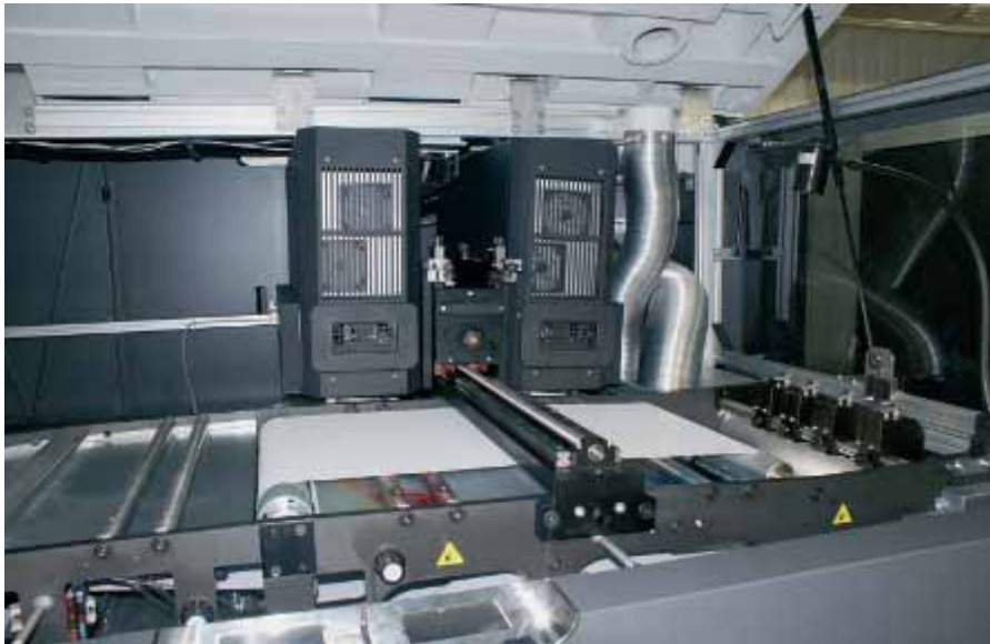
Tiskový engine disponuje dvojicí tiskových věží, v nichž jsou umístěny ink-jetové hlavy oždý pro dvojici inkoustů
